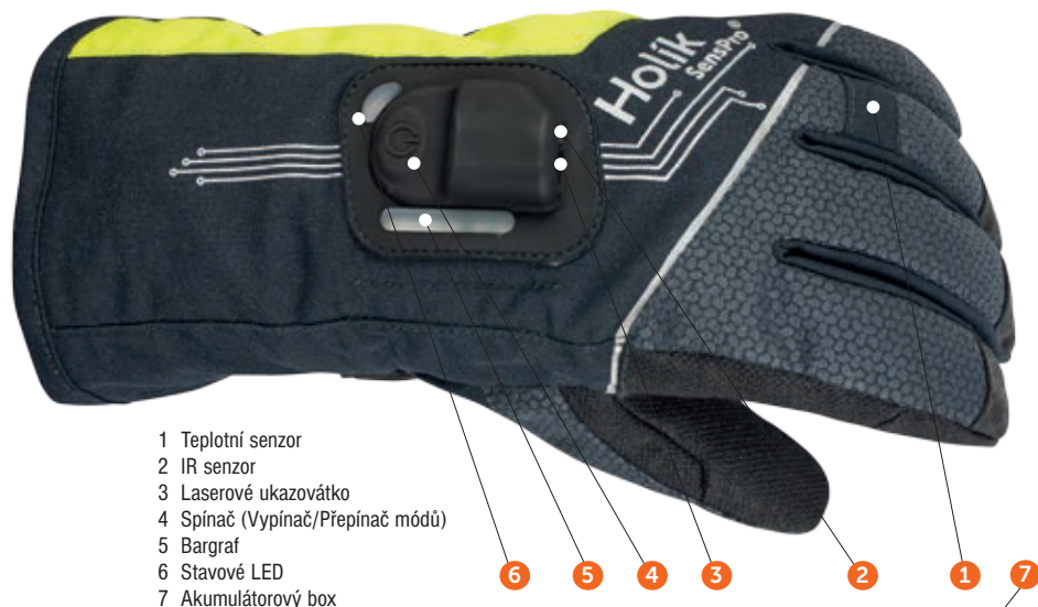
Obr. 1: Rozmístění funkčních prvků na hřbetové straně rukavice
